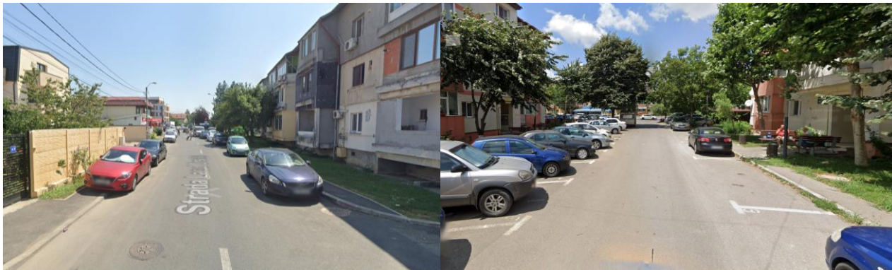
FIGURA 68. TROTUARE SUBDIMENSIONATE ȘI BLOCATE DE MAȘINI PARCATE NEREGULAMENTAR - ILFOV
