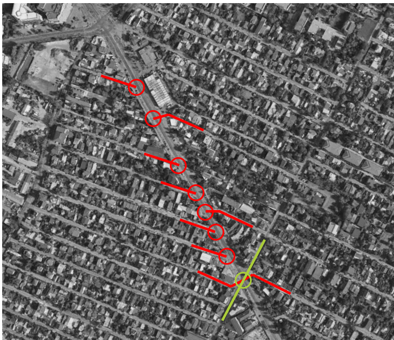
FIGURA 23. EXEMPLU DE INTERSECȚII DESE PE STRĂZI DE CATEGORIA I CU STRĂZI DE CATEGORIA III SAU IV
