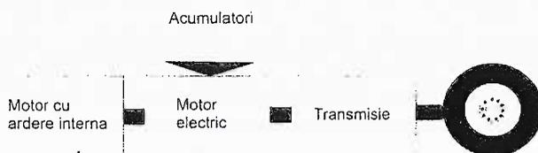
Un hibrid paralel are interpus un motor electric între cel termic și sistemul de transmisie.
